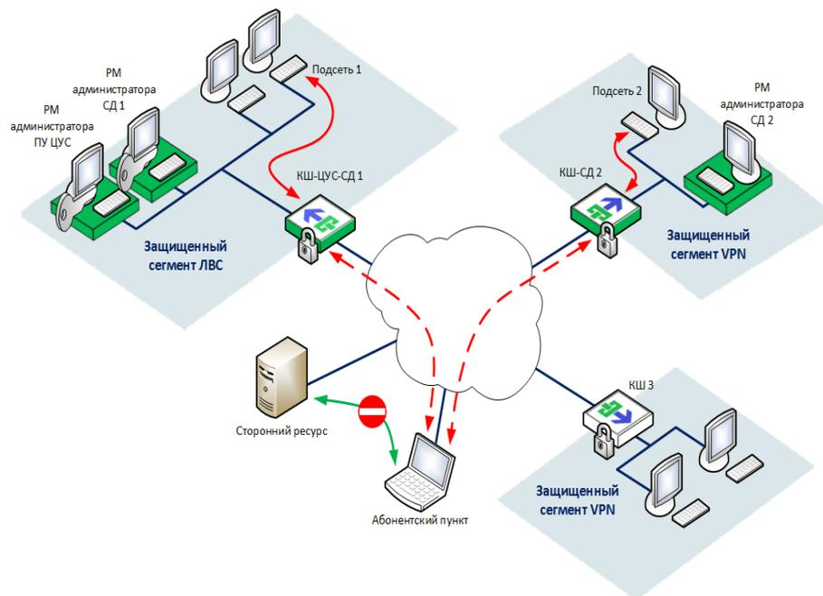
Для организации доступа удаленного пользователя к корпоративным ресурсам криптографический шлюз комплектуется сервером доступа, а на компьютере удаленного пользователя устанавливается абонентский пункт. Один сервер доступа обслуживает защищенные сети только того КШ, на котором он установлен.
